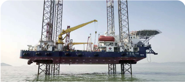
青岛海西重机有限责任公司 75米水深海上自升式勘测试验平台 (配华益 分离机) Qingdao Haixi Heavy Machinery Co., Ltd. 75m Depth Self-elevating Survey Platform (Equipped with Huayi separator)
